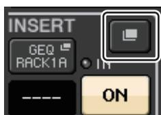
10. Premere il campo INSERT più lontano a destra per post fader nella schermata INSERT/DIRECT OUT 1ch.
