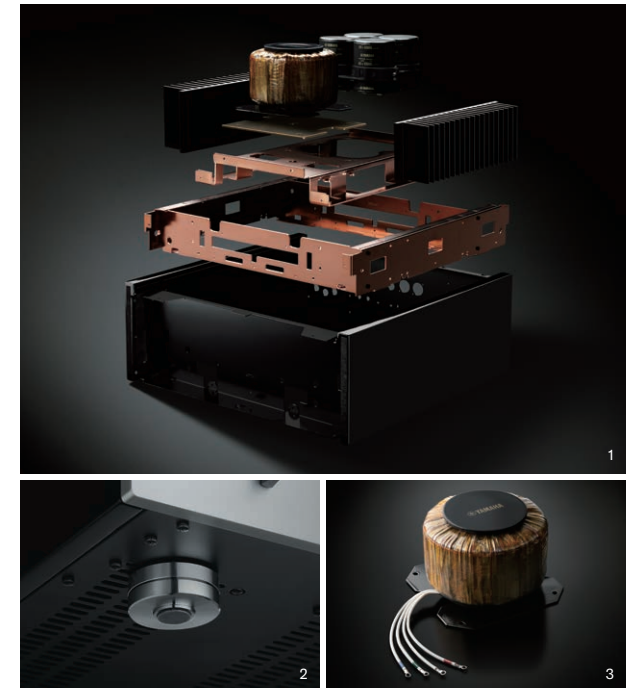
[1] Innovatives Chassis mit solider und geradliniger Konstruktion sowie mechanischer Erdung für massive und schwere Teile, die Vibrationen ausgesetzt sind, wie beispielsweise Leistungstransformatoren und Siebkondensatoren. [2] Neu entwickelte Füße aus Messing mit separater unterer und oberer Hälfte, die eine Montage sowohl auf Spikes als auch wahlweise mit einem Kratzschutz für empfindliche Oberflächen ermöglichen. [3] Massiver Ringkerntransformator mit einer Gesamtkapazität (links / rechts) von 1200 VA maximiert die überwältigende Kraft und Stärke der Tieftonwiedergabe.
