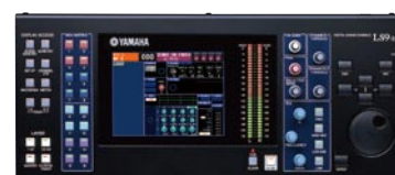
Pressione uma das 16 teclas MIX/MATRIX duas vezes e todas as demais teclas MIX/MATRIX acenderão enquanto o botão pressionado pisca. "SENDS ON FADER" também piscará no visor para indicar que o modo Sends On fader está ativo.
